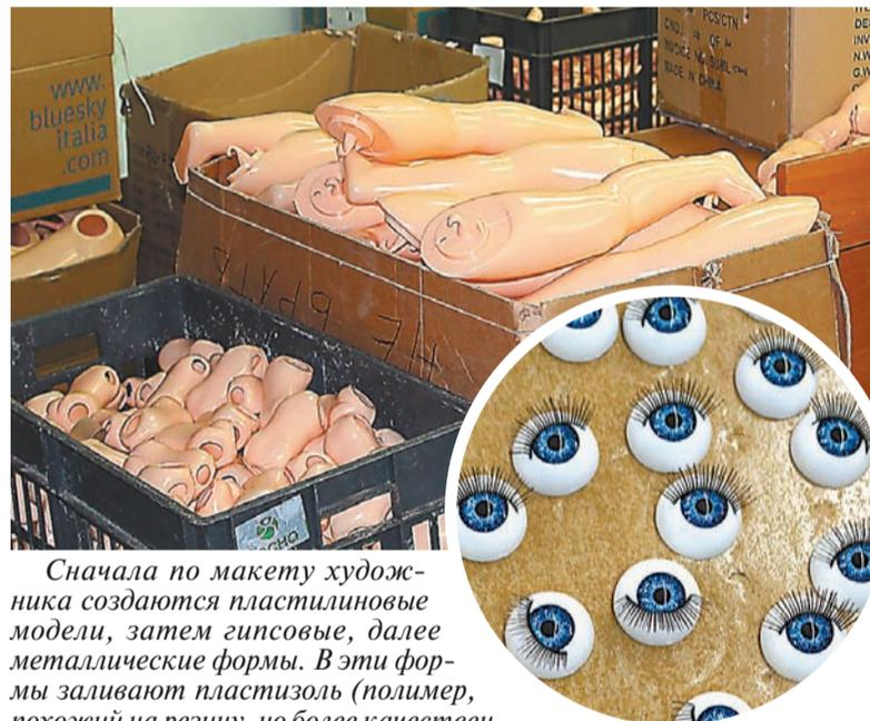
Сначала по макету художника создаются пластилиновые модели, затем гипсовые, далее металлические формы. В эти формы заливают пластизоль (полимер, похожий на резину, но более качественный и долговечный), из которого и делают детали куклы. А дальше форму ставят в печь для термообработки и... «выпекают» головы, туловища, ручки и ножки.
